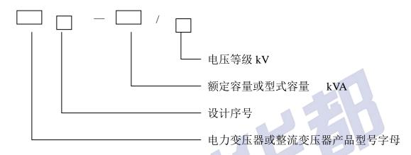
(如 S: 三相电力变压器; ZS: 三相整流变压器)
